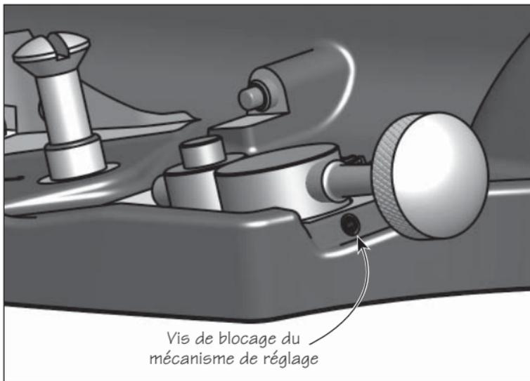
Desserrer la vis de blocage à l'aide d'une clé hexagonale de 1/16 po. Une fois le mécanisme de réglage de précision en place, serrer la vis de blocage suffisamment pour empêcher de retirer le mécanisme tout en lui permettant de pivoter.
